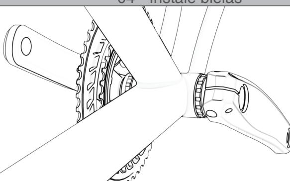
Engrase e Instale las bielas siguiendo los pasos de montaje del fabricante.
